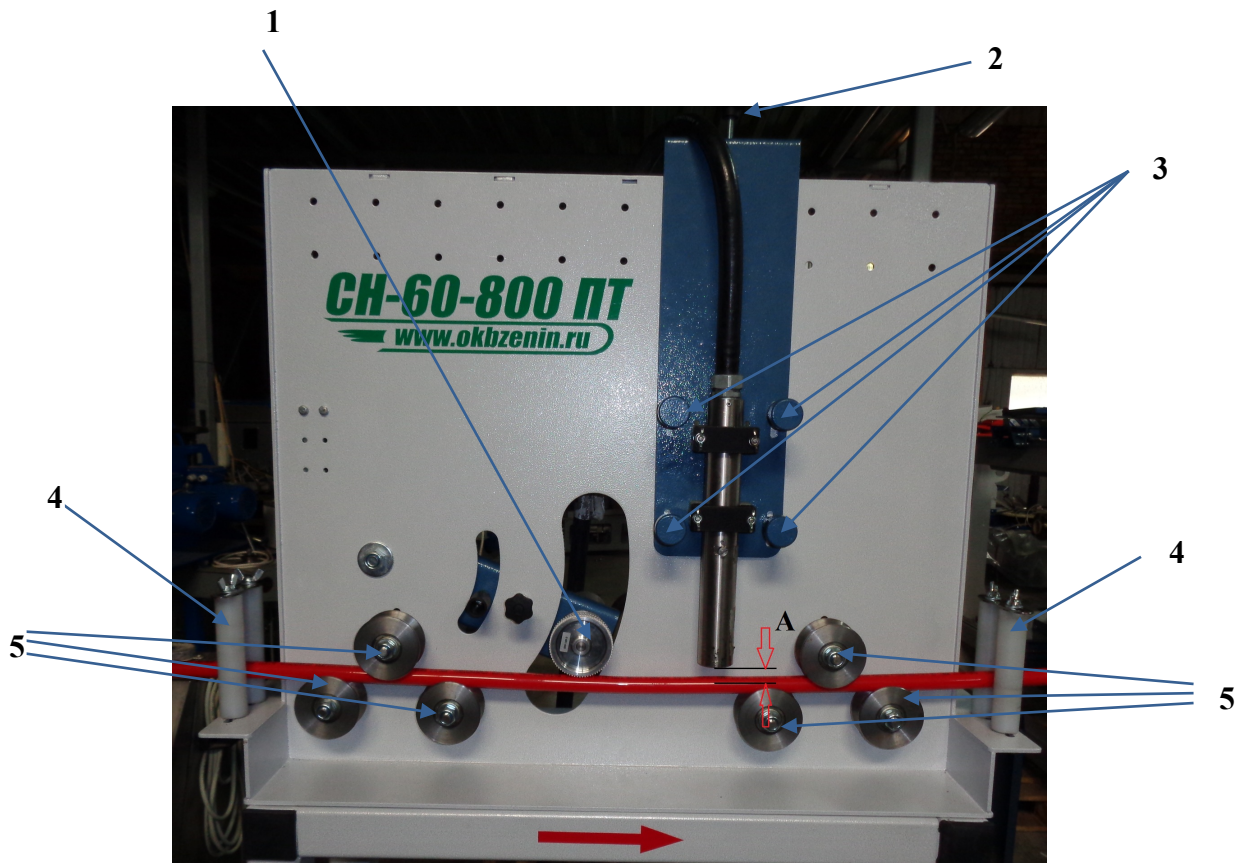
Рисунок 4 - Подставка для маркировки трубы при помощи цифрового маркера
