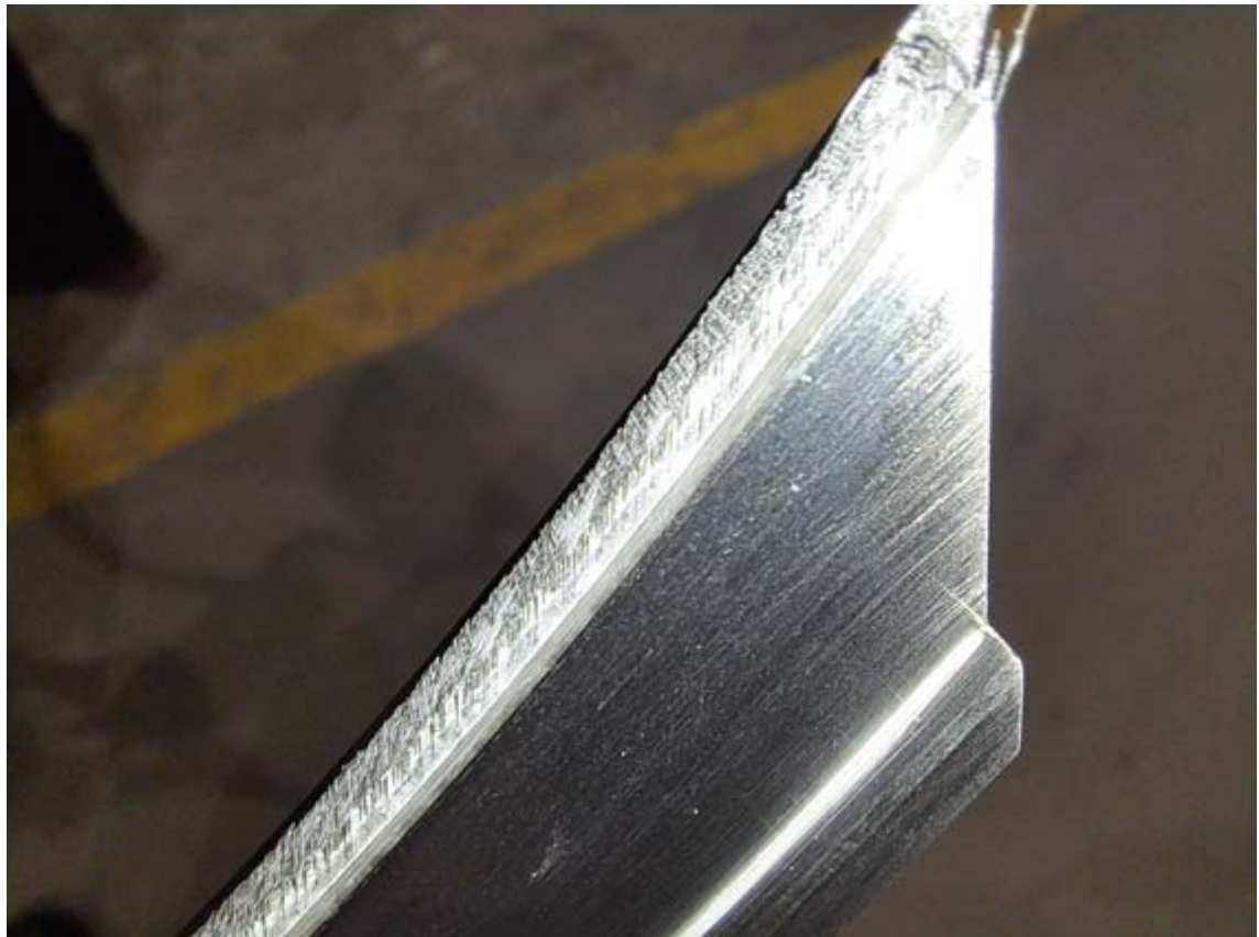
Рис. 5 Щеточное уплотнение. Вид со стороны щетки. Щетина залита воском.
