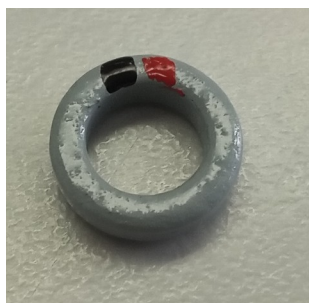
Сердечник К10х6х3 покрыт эмалью.
