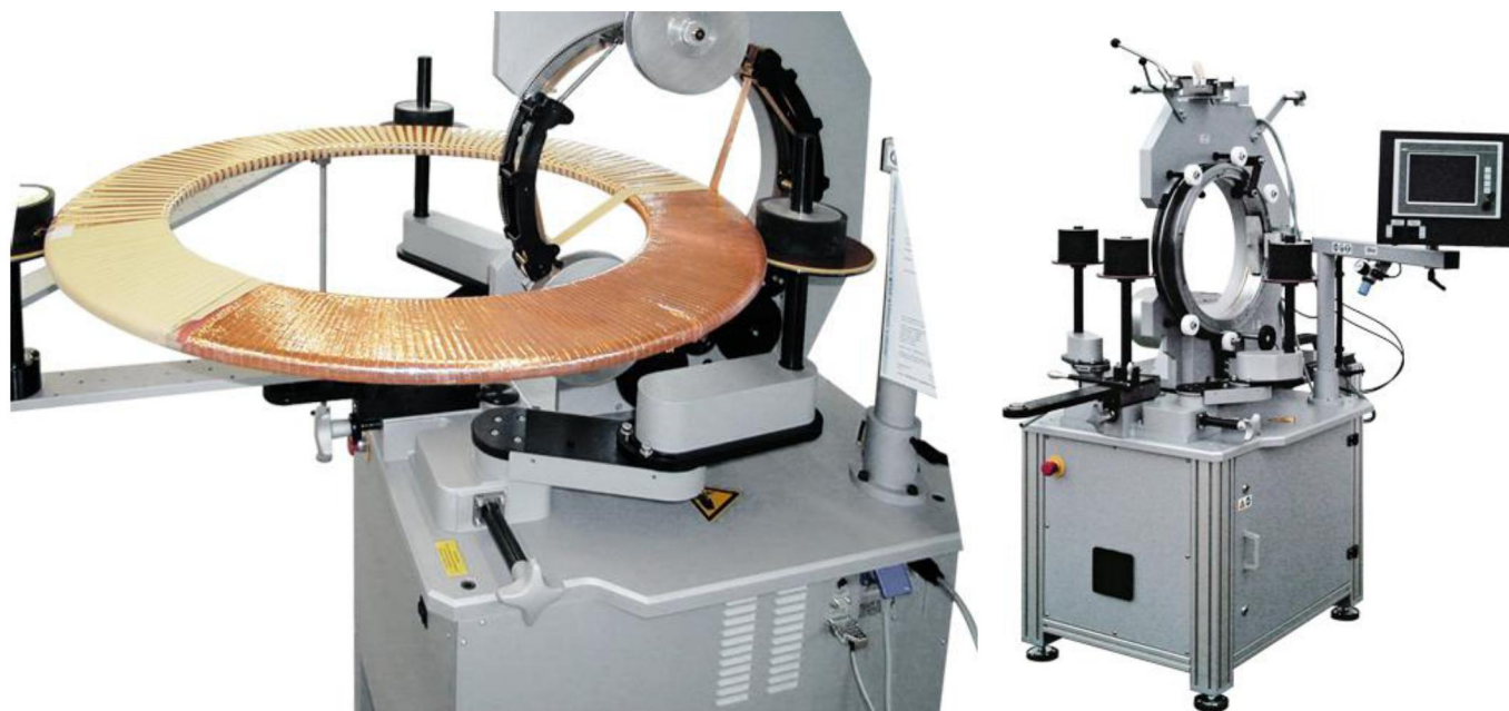
Фото 1 станок для изготовления емкостных колец для силовых трансформаторов
