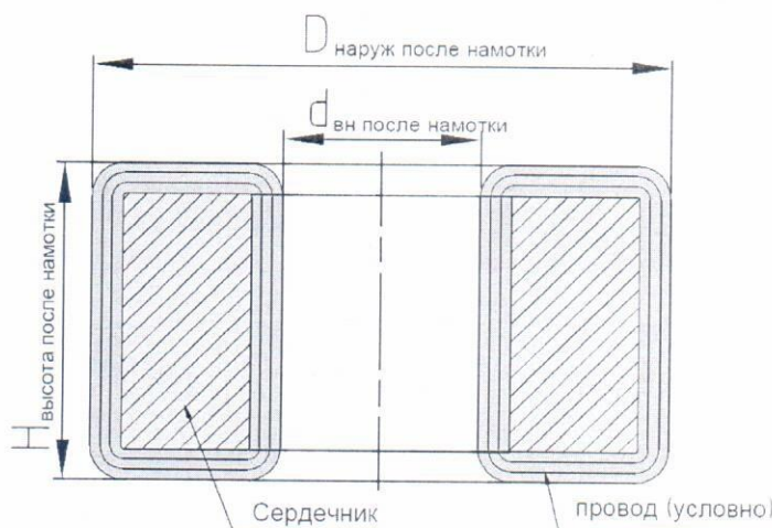
Рисунок 2. Сердечник после намотки
