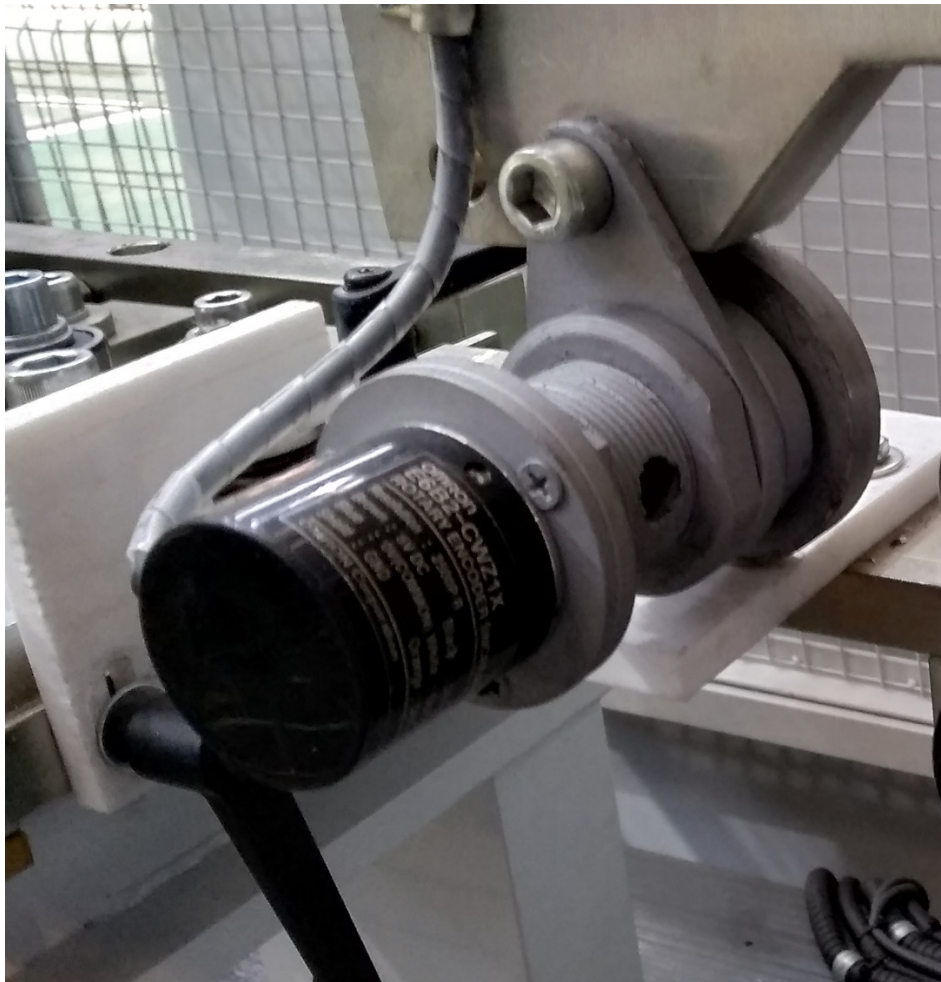
Рис. 5 Модуль измерения длины протянутой шины
