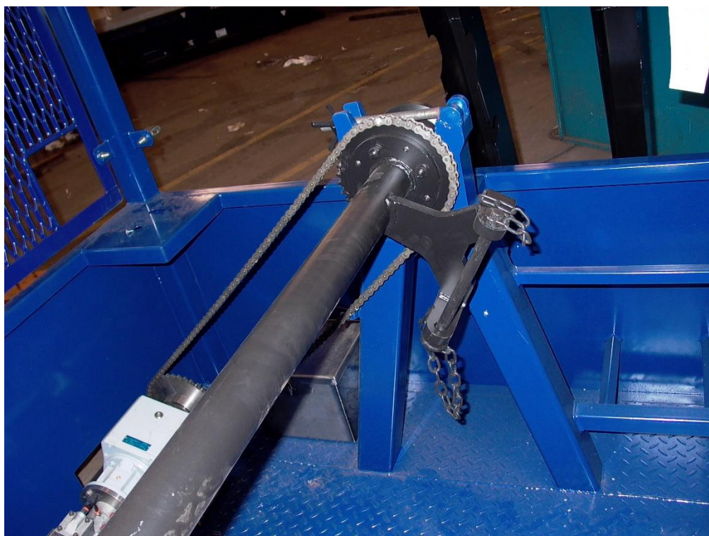
Цепная передача от мотора к валу.
