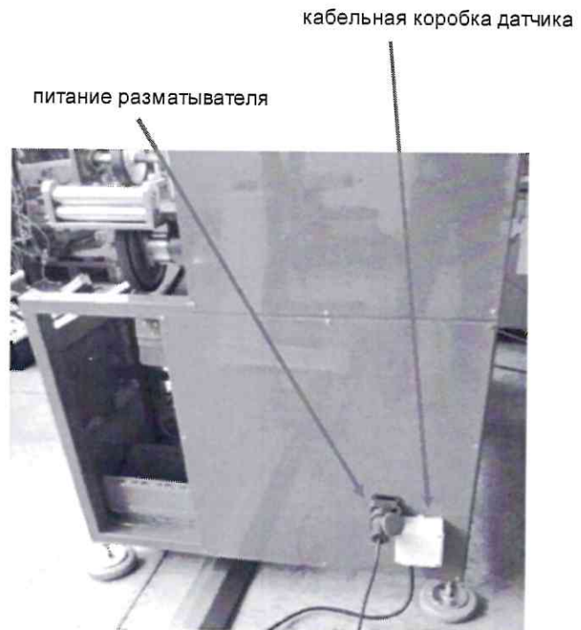
Рис.2.4.2.1 Подключение станка намотки к разматывателю
