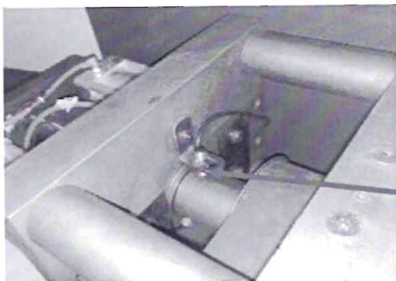
7.1.9 - НЕПРАВИЛЬНОЕ ПОЛОЖЕНИЕ ЦЕНТРАЛЬНОЙ ГОЛОВКИ Проверьте датчик центральной головки (в задней части) !
