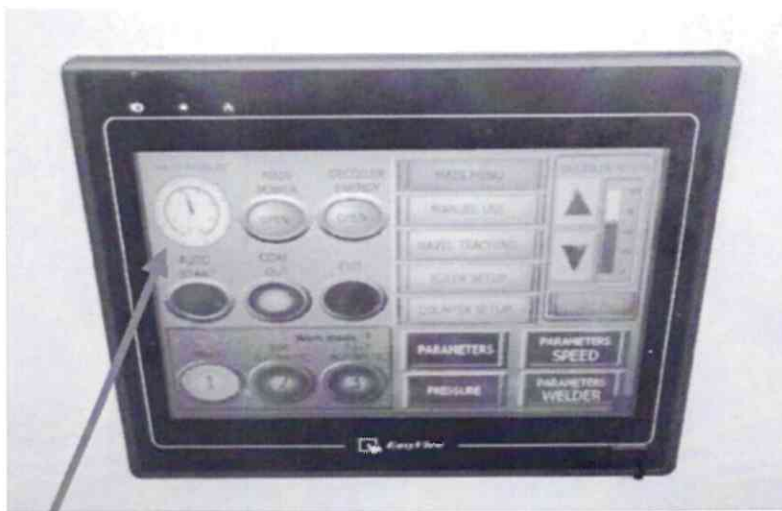
Рис.5.1 Рекомендуемое давление воздуха 7-8 бар
