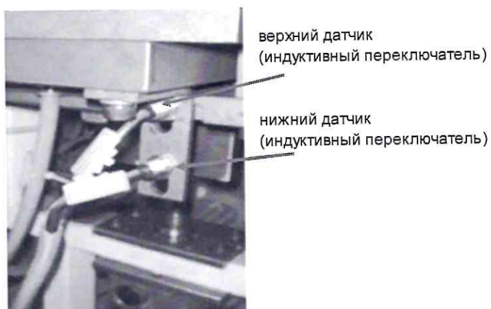
Рис. 2.3.13 датчики поршня 7 (устройства резки) (NPN NO , рабочее расстояние 4 мм, 10-30 В постоянного тока)
