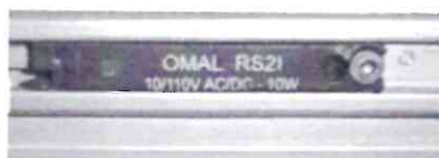
Рис. 2.3.5 общий вид датчика поршня Omal RS21
