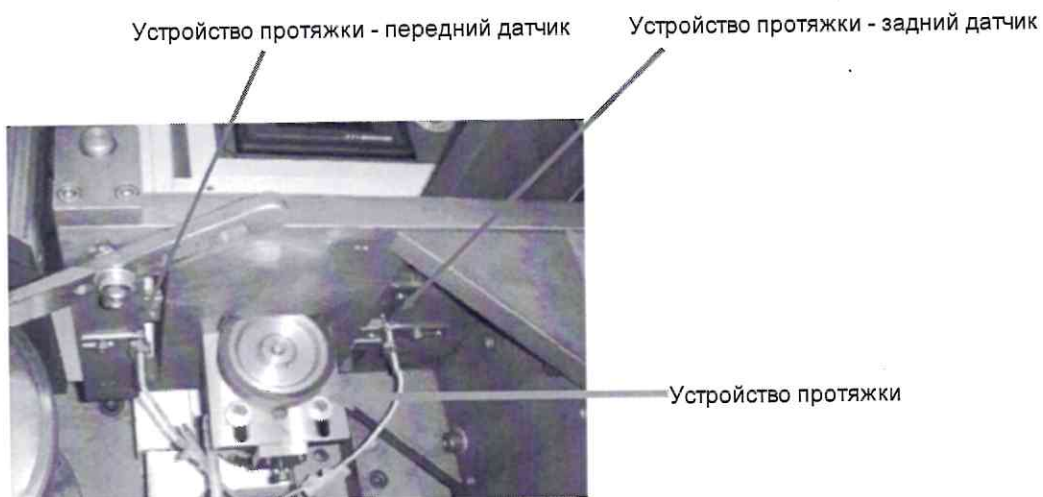
Рис. 2.3.14 Устройство протяжки (расположение датчиков) (NPN NO , рабочее расстояние 4 мм, 10-30 В постоянного тока)
