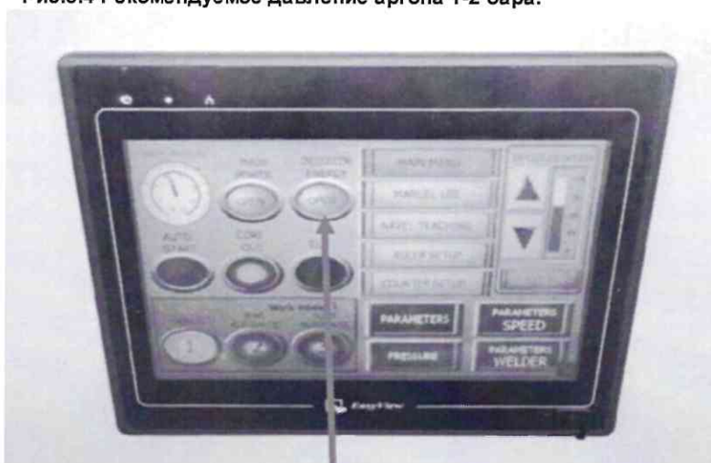
Рис.5.5 Разматыватель должен быть включен - положение 1 или 2 (см. 2.4.3)
