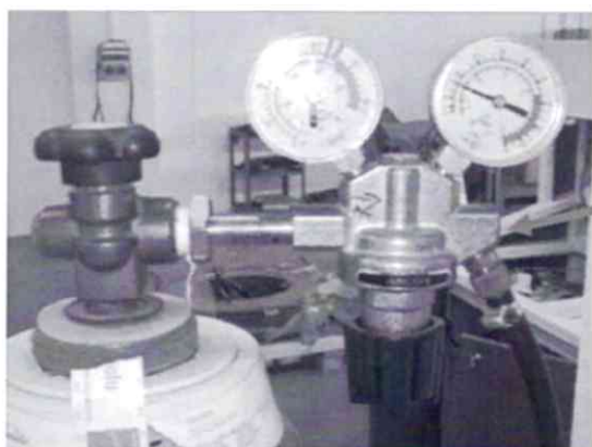
Рис.5.4 Рекомендуемое давление аргона 1-2 бара.
