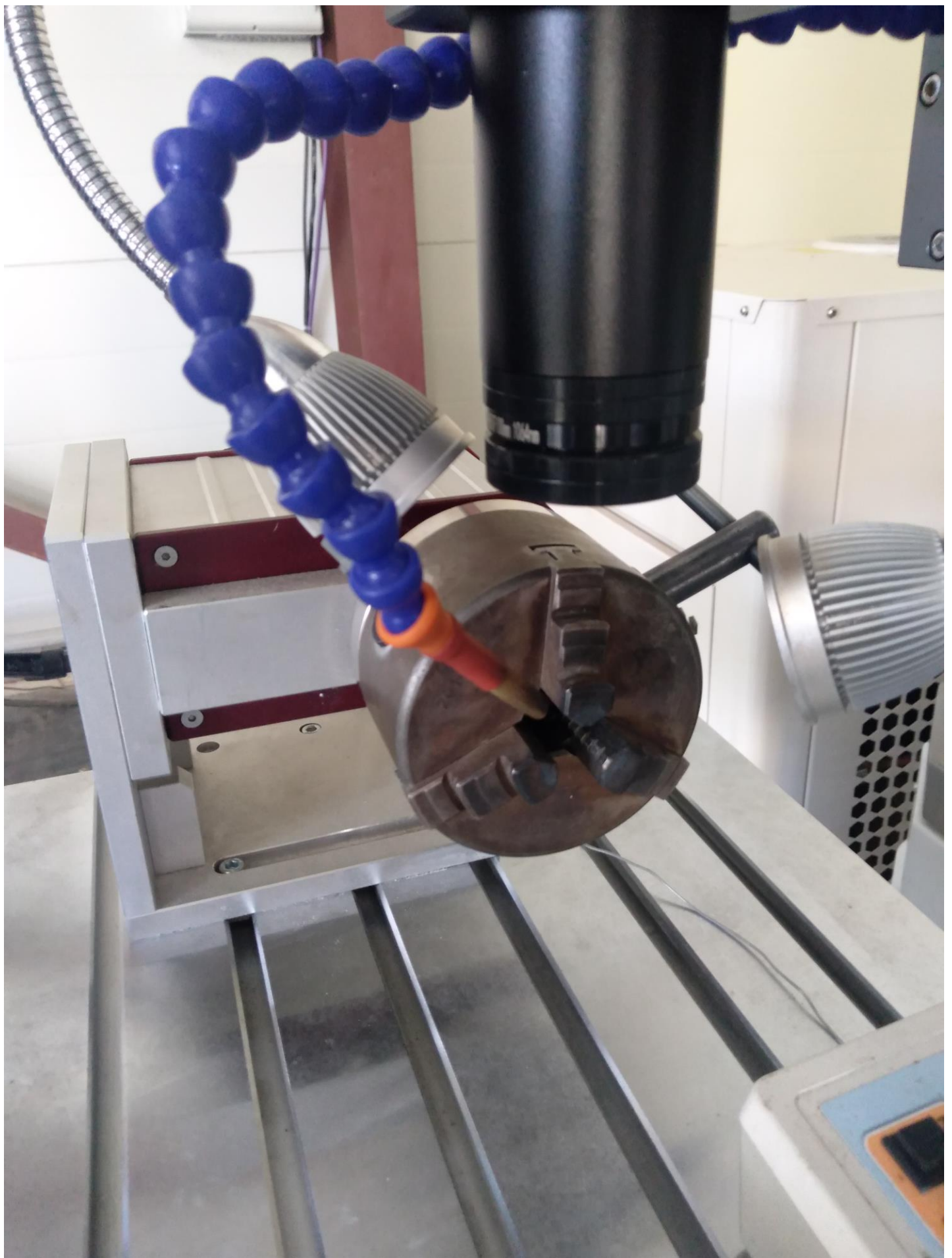
Фото 3 –Установка лазерной сварки (общий вид вращателя)
