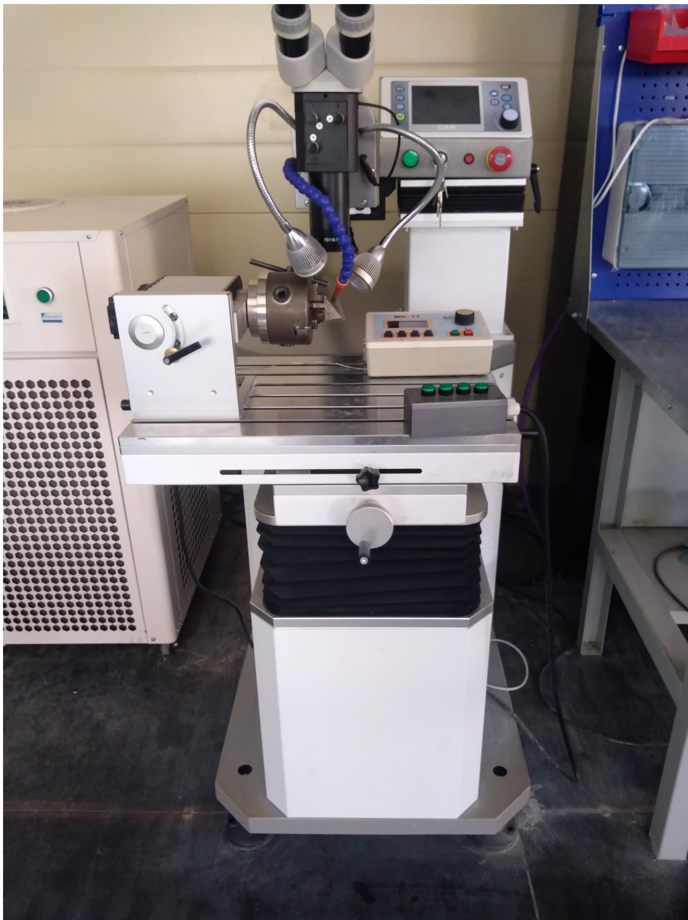
Фото 1 –Установка лазерной сварки (фронтальный вид)
